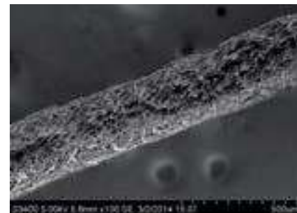
Контактный пористый дренаж, профиль
